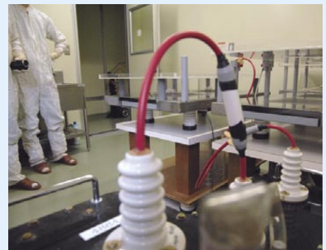
0 から 3 万ボルトまでの電圧をかけて電界を作り出す装置。
